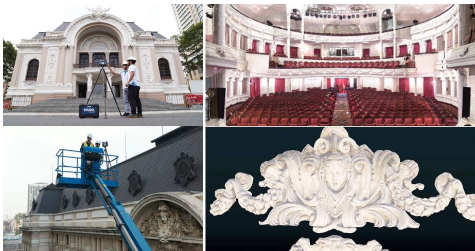
Hình 11a. Quét laser 3D phần mặt tiền và mái tại nhà hát
