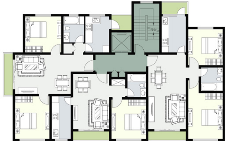
Hình 4. Mặt bằng nhà dạng đơn nguyên, thiết kế 2009. Mỗi căn hộ có diện tích là 58, 80, và 85m 2 .
