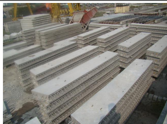
Tấm panel dự ứng lực các loại với chiều dài tấm từ 3 - 8m (Nguồn: internet)
