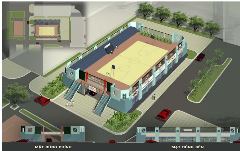
Hình 3.14-Giải pháp kết hợp nhà để xe với sân chơi bóng rổ
