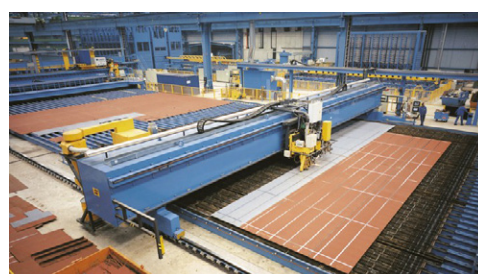
Phân xưởng cắt, hàn tự động bằng laser, điều khiển bằng máy tính
