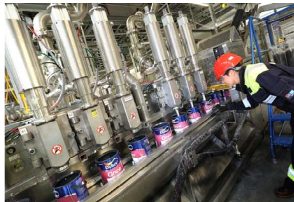
Công đoạn chiết rót sơn vào hộp
