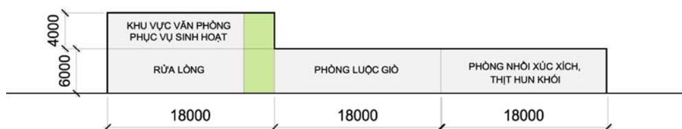
Sơ đồ mặt cắt phân xưởng chế biến
