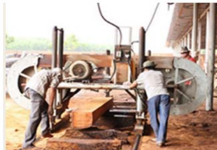
Xẻ gỗ nhỏ theo kích thước sản phẩm
